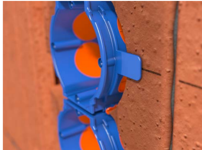
Durch die seitlichen Laschen ist die Putzstärke von 1 cm vorgegeben.
