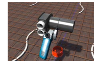
Stutzen auf die gewünschte Länge kürzen.
