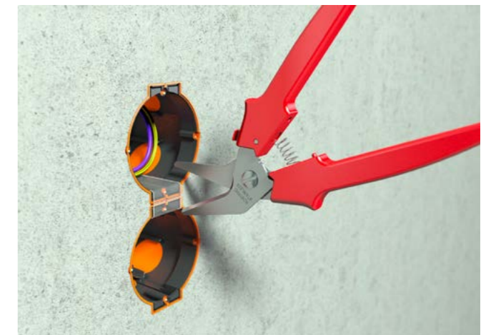
Bei Bedarf kann der SCS-Verbindungssteg mit einem Dosencutter (P845) ausgebrochen werden.
