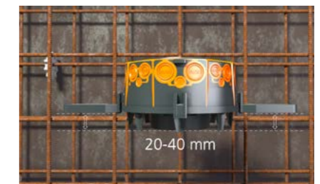
... oder um 180° gedreht für 20 – 40 mm Betonüberdeckung.
