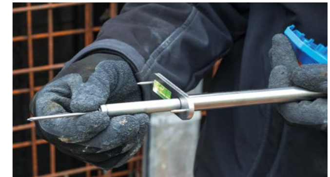
Nagel mit Magnet aufnehmen.
