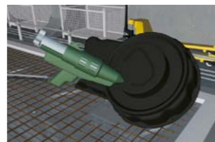
Betoneinbaugehäuse XL 300 Flex mit Trafo mit Heißkleber auf den Schaltisch kleben.
