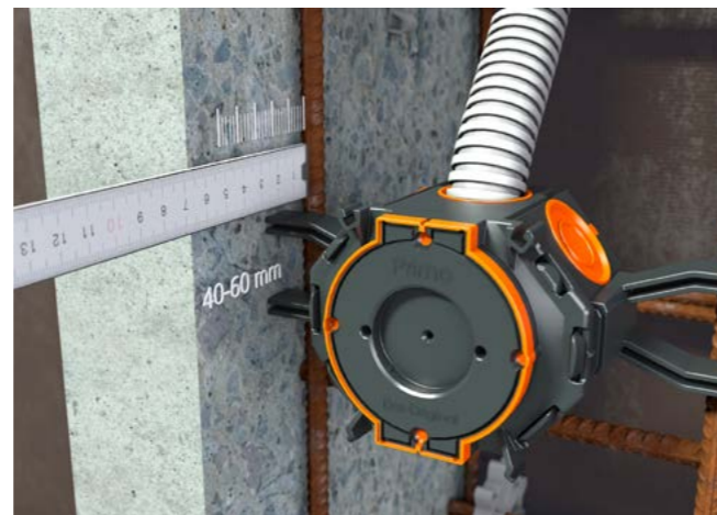
... oder um 180° gedreht für 40 – 60 mm Betonüberdeckung.
