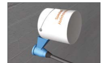
Spezialabdichtmasse an der Gebäudeaußenseite (tiefste Stelle) einfüllen bis die Masse im Trichter hochsteigt.
