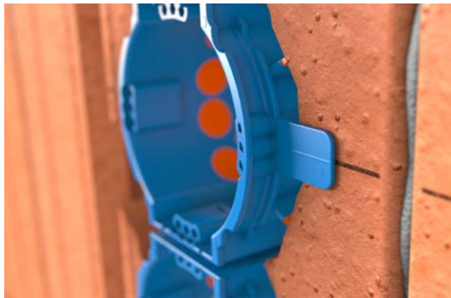
Durch die seitlichen Laschen ist die Putzstärke von 1 cm vorgegeben.
