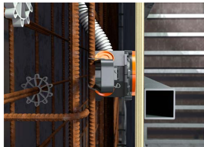
Flexible Flügel passen sich der jeweiligen Betondeckung an. Betondeckungen zwischen 20 – 40 mm oder 40 – 60 mm. Nach dem Stellen der Gegenschalung kann betoniert werden.
