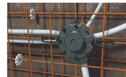
Membrane mit einem Cuttermesser öffnen. Werkzeuglose Kombi-Einführung von Kabeln und (starken) Rohren von M9-M40. Die Membrantechnik gewährt eine absolut betondichte Einführung.
