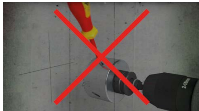
Herkömmliches und zeitaufwändiges Entfernen des Bohrkerns.
